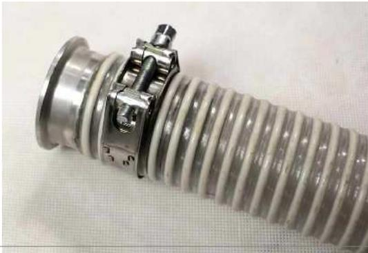
Deslizar el conector en la manguera y fijarlo
