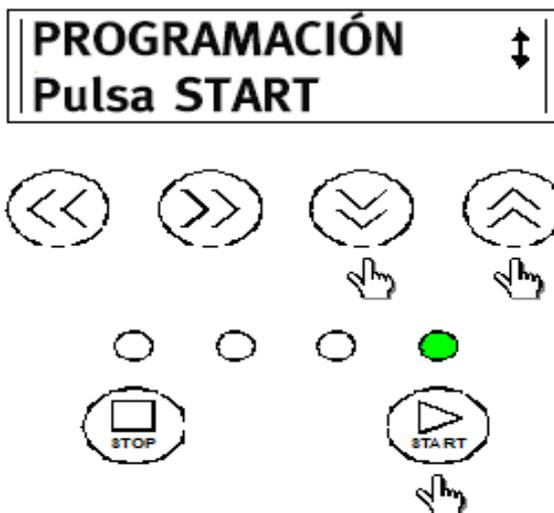
**Fig.2. Selección y confirmación del modo de programación**
