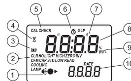
1. El esquema de medición (lámpara, cubeta, detector), aparece durante diferentes fases de la puesta a cero o de la medición
