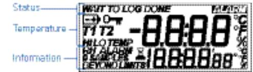
La pantalla LCD presenta un amplio rango de temperatura y ángulo de visión. Muestra la siguiente información: estado: primera línea en la parte superior, temperatura de lectura: línea media e información adicional: línea inferior.
